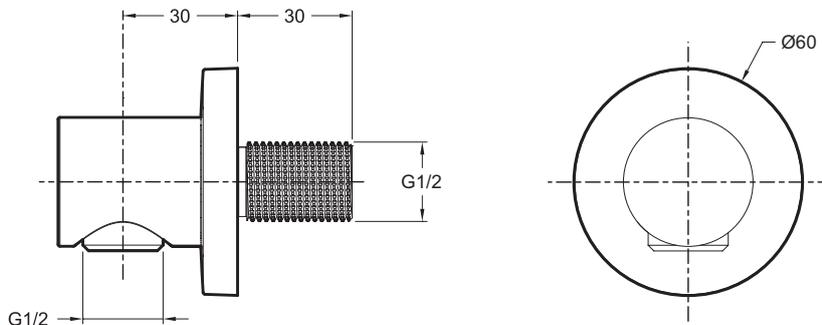
Спецификация продукта : Коленное соединение для душевого шланга. E8465. Коллекция : MODULO. РАЗМЕРЫ (СМ) : 6 x 6 см. ВЕС : 0.4 кг. МАТЕРИАЛ : N/A. ТИП УСТАНОВКИ : Крепление к стене. АКСЕССУАРЫ : Коленное соединение. ДИЗАЙН : КРУГЛЫЙ СОВРЕМЕННЫЙ. НЕВОЗВРАТНЫЙ КЛАПАН : Да. С обратным клапаном.
